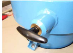
injecteur de la turbine
