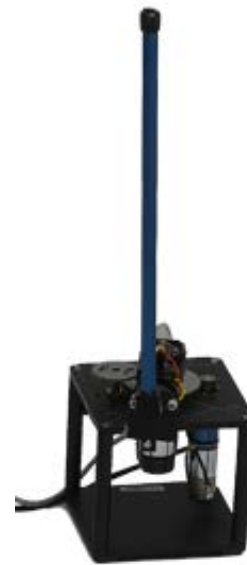
Figure 1.2: Pendule régulé en position haute.
