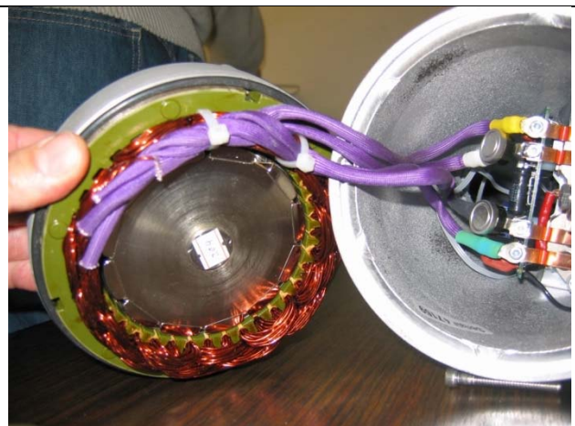
Fig n°2 Photo de l'alternateur de la machine et de son électronique embarquée.
