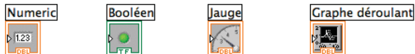
(b) Exemples de terminaux d'indicateurs sur le diagramme . Les commandes sont encadrées en traits fins . L'icône permet de repérer la commande, la couleur traduit le type :
