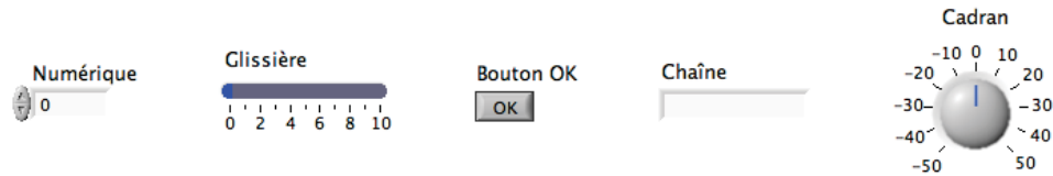
(a) Exemples de commandes sur la face avant . On peut redéfinir les bornes d'une commande numérique avec l'outil "doigt" ou "A" : sur le cadran, on a changé 0,10 en -50,50.
