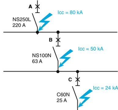
Le disjoncteur de tête A est un NS250L (PdC : 150 kA) pour un  $I_{cc}$  présumé à ses bornes aval de 80 kA.
