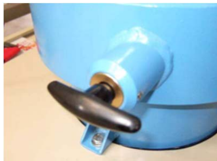
Figure 7: injecteur de la turbine
